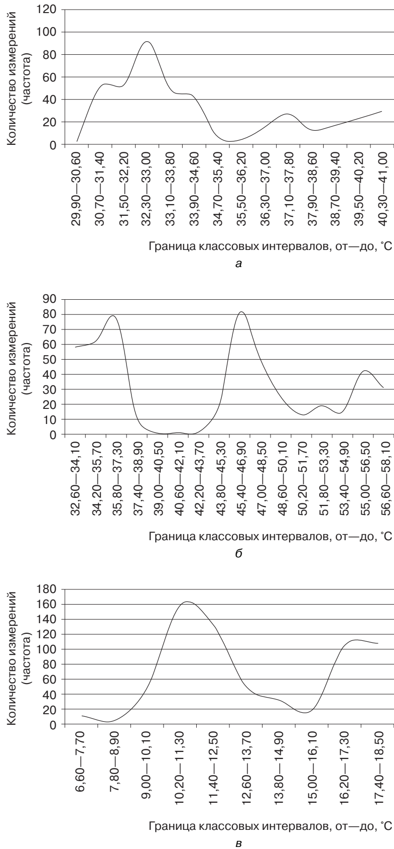
Рис. 2. Распределение значений температуры в поверхностном слое свалочных тел полигонов ТБО: а — полигон ТБО ГУП «Андреевская долина»; б — полигон ТБО МУП «Вторсырье»; в — полигон ТБО «Хметьево»
